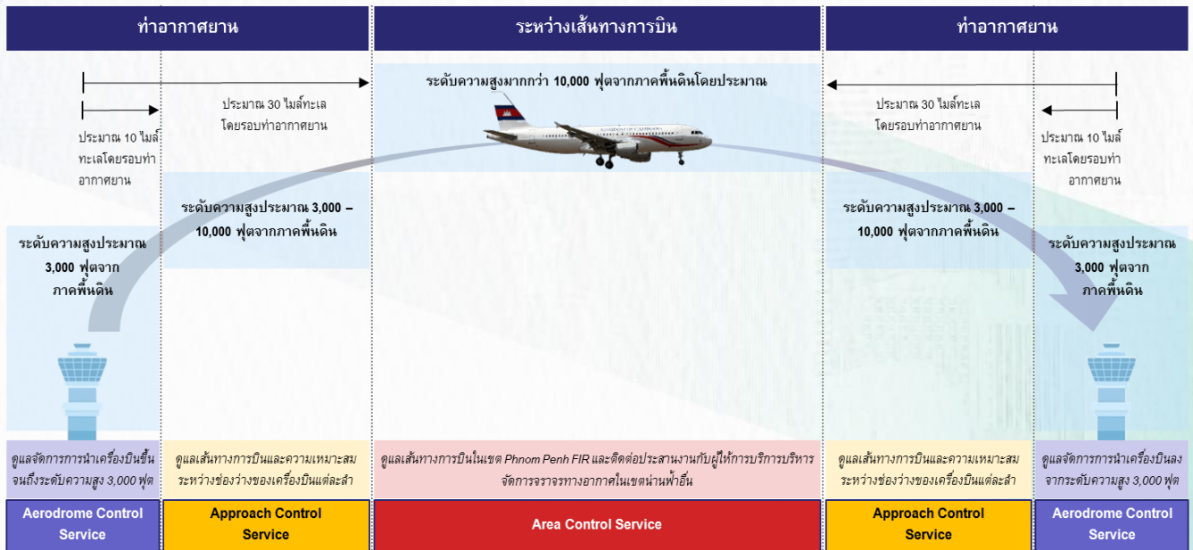
แผนภาพจำลองการปฏิบัติงานของแต่ละหน่วยงานควบคุมการจราจรทางอากาศ
